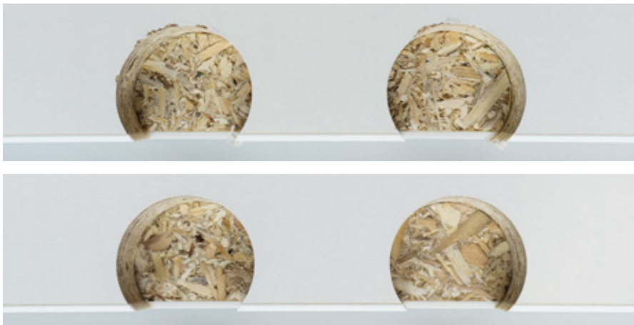
Bild oben: Randbohrungen für Topfbänder mit herkömmlichen Beschlaglochbohrern.
